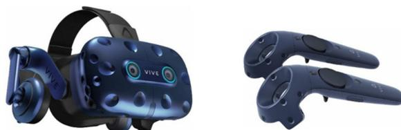
图3 虚拟现实技术的基本硬件包含一个头戴显示器和两个手柄
