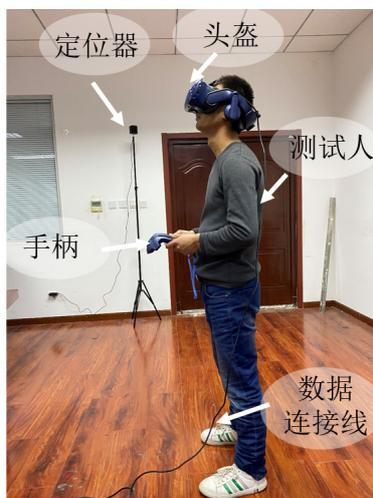
图4 Manta工具所需的硬件设备展示图
